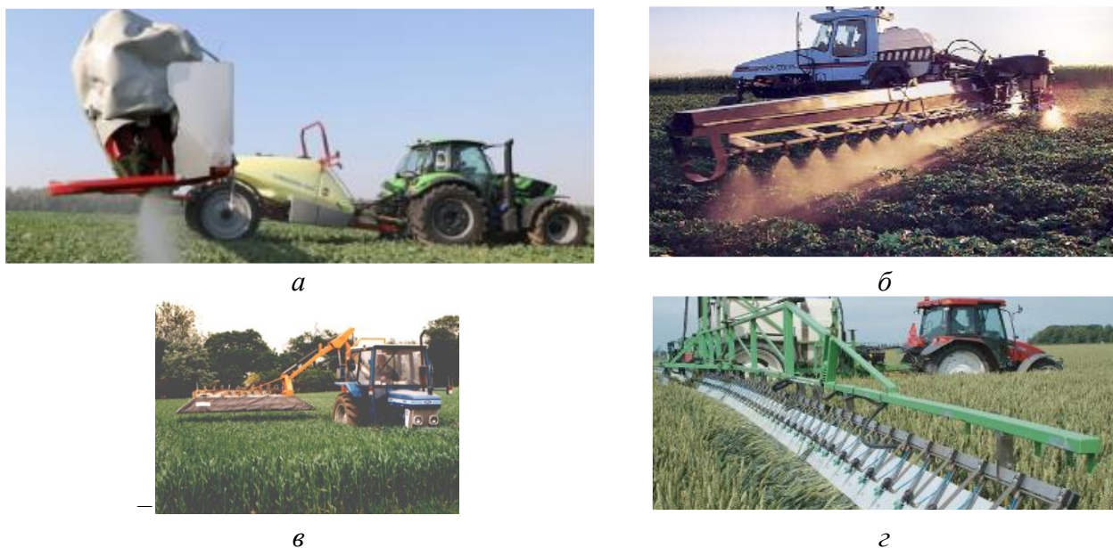
Рис. 2. Системы, снижающие снос рабочих растворов при опрыскивании:
