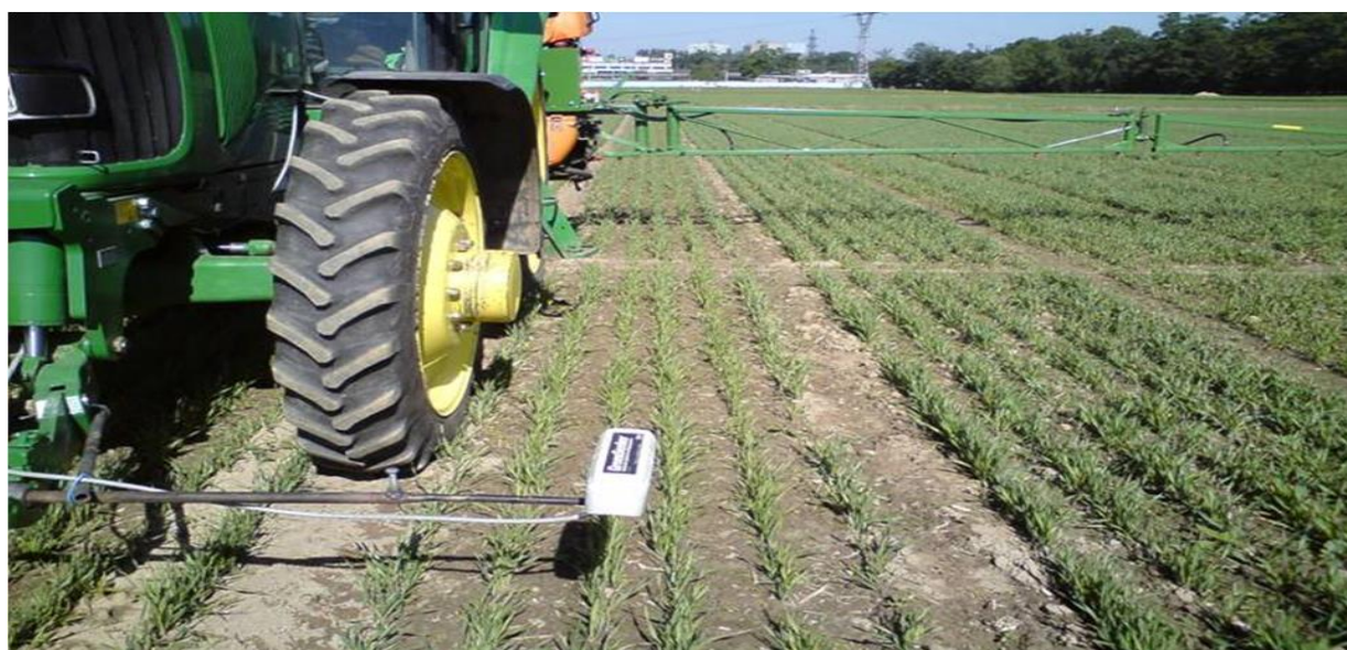
Рис. 4. Сенсорный датчик GreenSeeker
