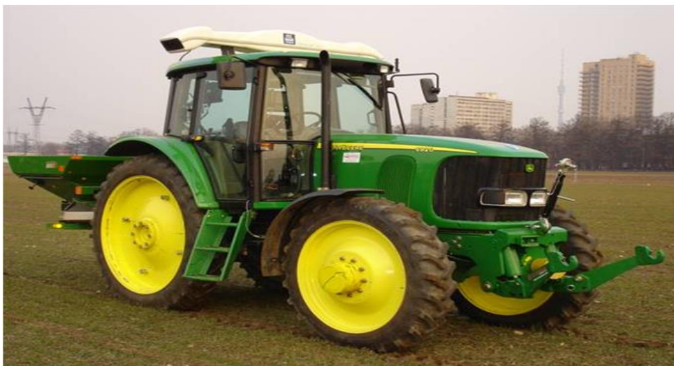
Рис. 5. Сенсорный датчик N-sensor ALS
