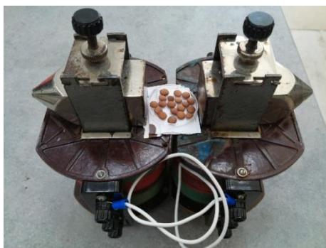
Рис. 1. Экспериментальная установка для предварительной обработки семян магнитным полем
