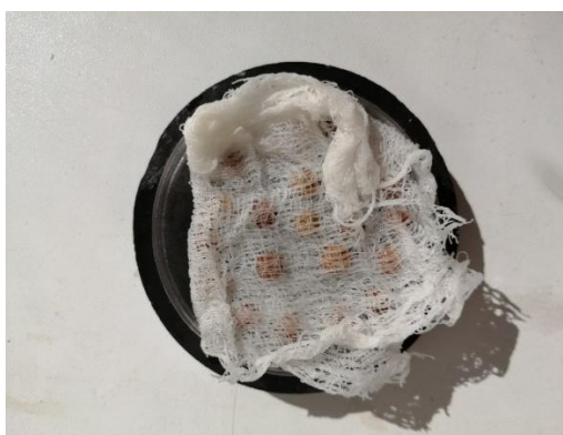
Рис. 3. Экспериментальная установка для постоянной обработки семян магнитным полем ферритового магнита
