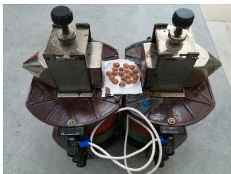
*Рис. 1. Экспериментальная установка для предварительной обработки семян магнитным полем*
