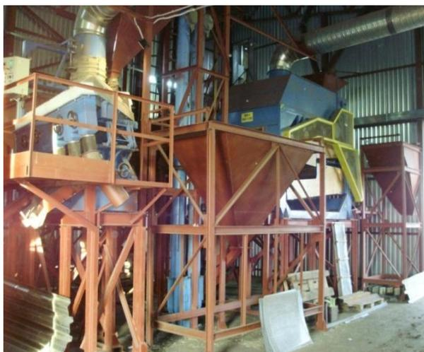
Рис. 3. Отделение сортирования с семяочистительной машиной МВУ-1500, пневмостолом МОС-9Н и перегрузчиком 2К
