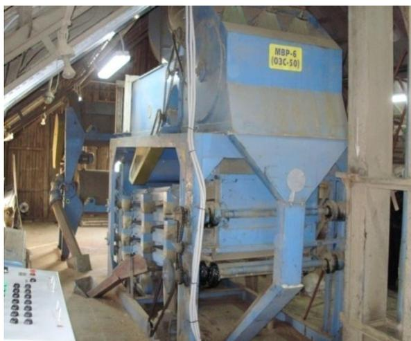
Рис. 2. Отделение первичной очистки с зерноочистительной машиной ОЗС-50 и триерным блоком БТЦ
