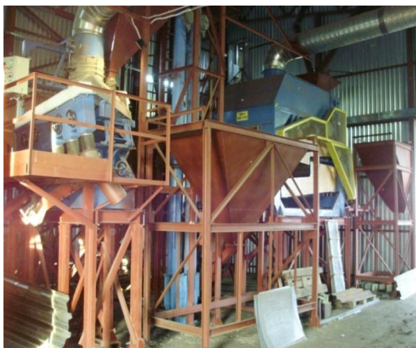
Рис. 3. Отделение сортирования с сеяноочистительной машиной МВУ-1500, пневмостолом МОС-9Н и перегружчиком 2К
